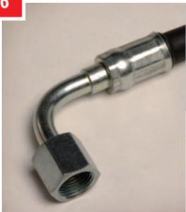
Per rendere più sicura la tenuta, ripetere l'operazione di raccordatura ruotando il manicotto di due o tre lati.
