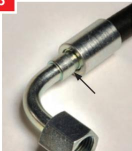
Infilare il dado sul raccordo e poi introdurre l'inserto nel tubo fino in battuta.
