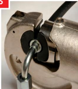
Posizionare il manicotto in corrispondenza della fine del morsetto e procedere con la raccordatura.
