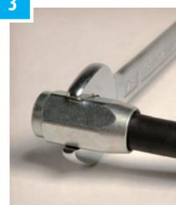
Impugnare il tubo e avvitare il manicotto in senso antiorario con apposita chiave sino a portare il tubo a circa 2-3 mm dalla battuta interna.
